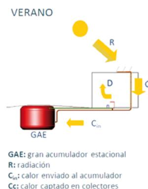
Fig. 1. Sistema de Climatización y Agua Caliente Sanitaria (SCACS) con energía solar.
